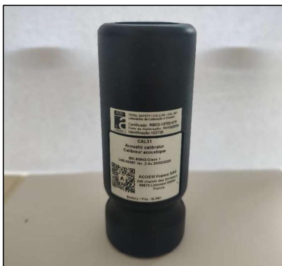
Figura 5: Calibrador acústico modelo CAL31, marca 01dB.
